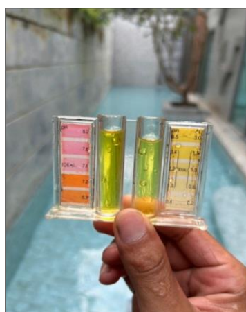
รูปที่ 3-48 เจ้าหน้าที่ตรวจวิเคราะห์ปริมาณคลอรีนและความเป็นกรด-ด่างของน้ำในสระว่ายน้ำ
