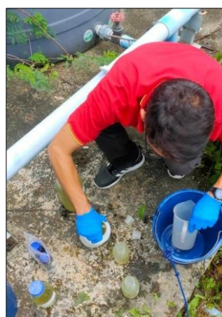
รูปที่ 3-10 เก็บตัวอย่างน้ำใช้ไปวิเคราะห์
