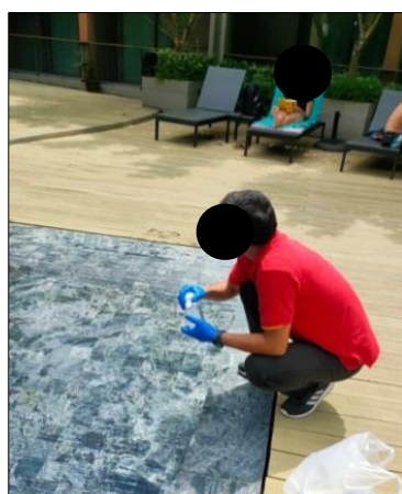
รูปที่ 3-48 เจ้าหน้าที่ตรวจวิเคราะห์ปริมาณคลอรีนและความเป็นกรด-ด่างของน้ำในสระว่ายน้ำ
